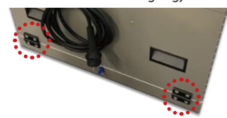
Steg 1 - Lossa de två låsskruvarna på inspektionssidan.
